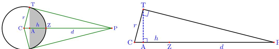
El triángulo CTP es un triángulo rectángulo por ser T un punto de tangencia.
